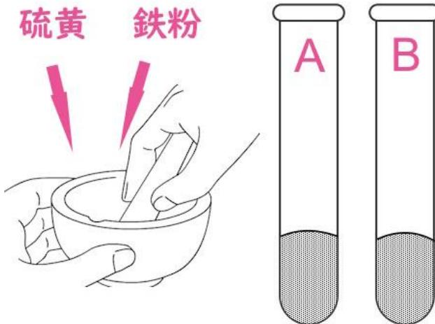
2. 硫黄と鉄粉をよく混ぜ、その混合物を試験管 A・B に入れ、試験管 A を加熱した。
